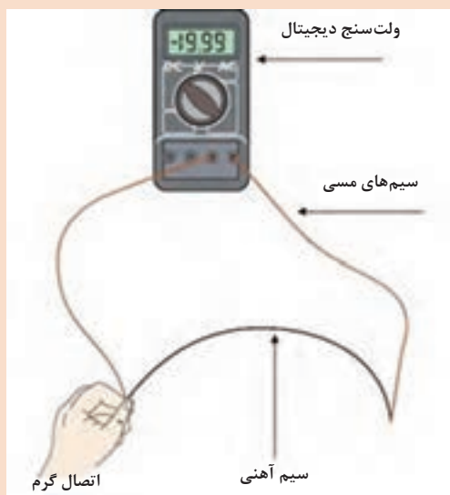
شکل ۲۲- ساخت یک ترموکوپل ساده
